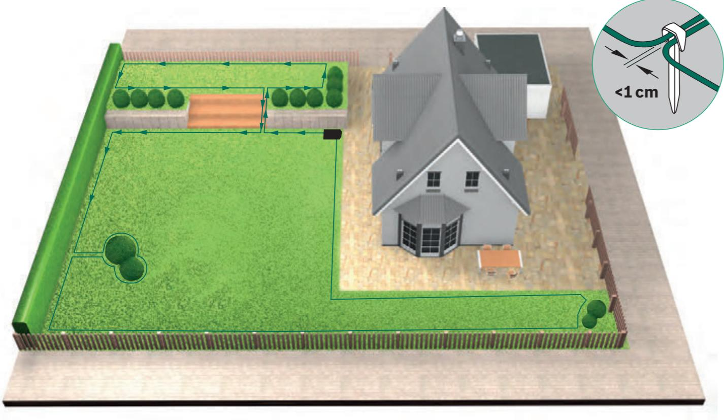
5.5 A határoló vezeték lefektetése elhatárolt kertek körül (C típus lásd az 1. fejezetet).
