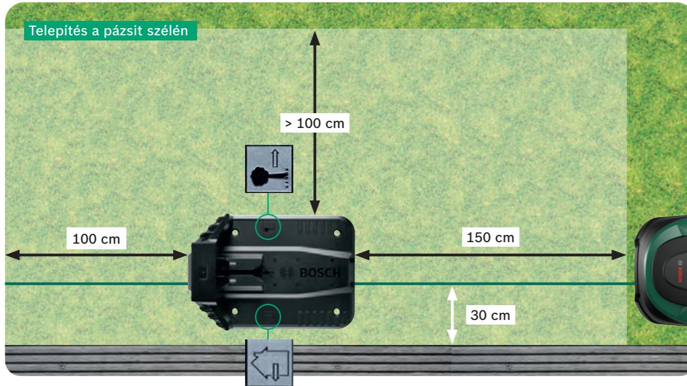
! Az alapegység fontos referenciapont az Indego készülék számára. Kerülendő a képeken látható telepítéstől való bármilyen eltérés, mivel az problémákat okozhat az Indego navigációjában és működésében.
