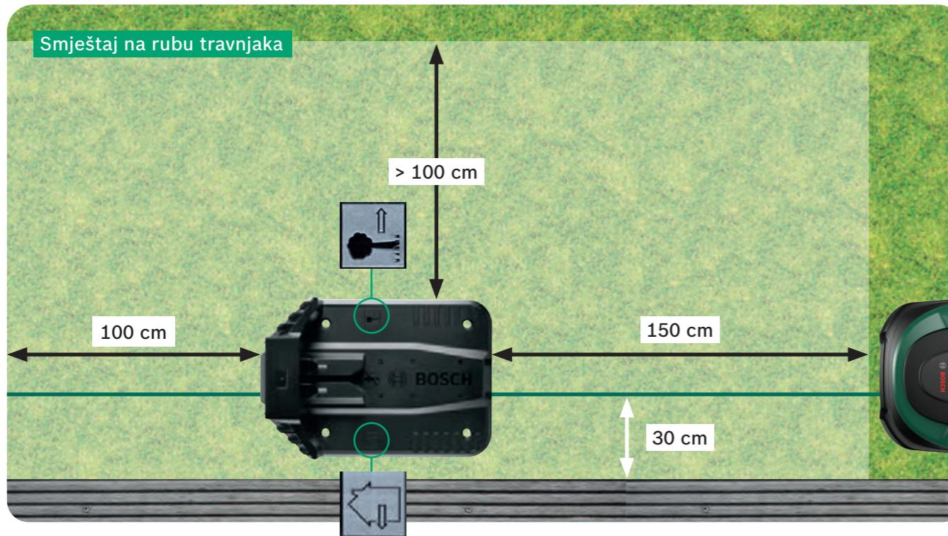
**!** Priključna stаница важна је referentna тачка за вај Indego. Свако одступање од инсталације приказане на сликама може узроковати проблеме с навигацијом/уџинковитошћу вајег уређаја Indego и стога се треба избегавати.
