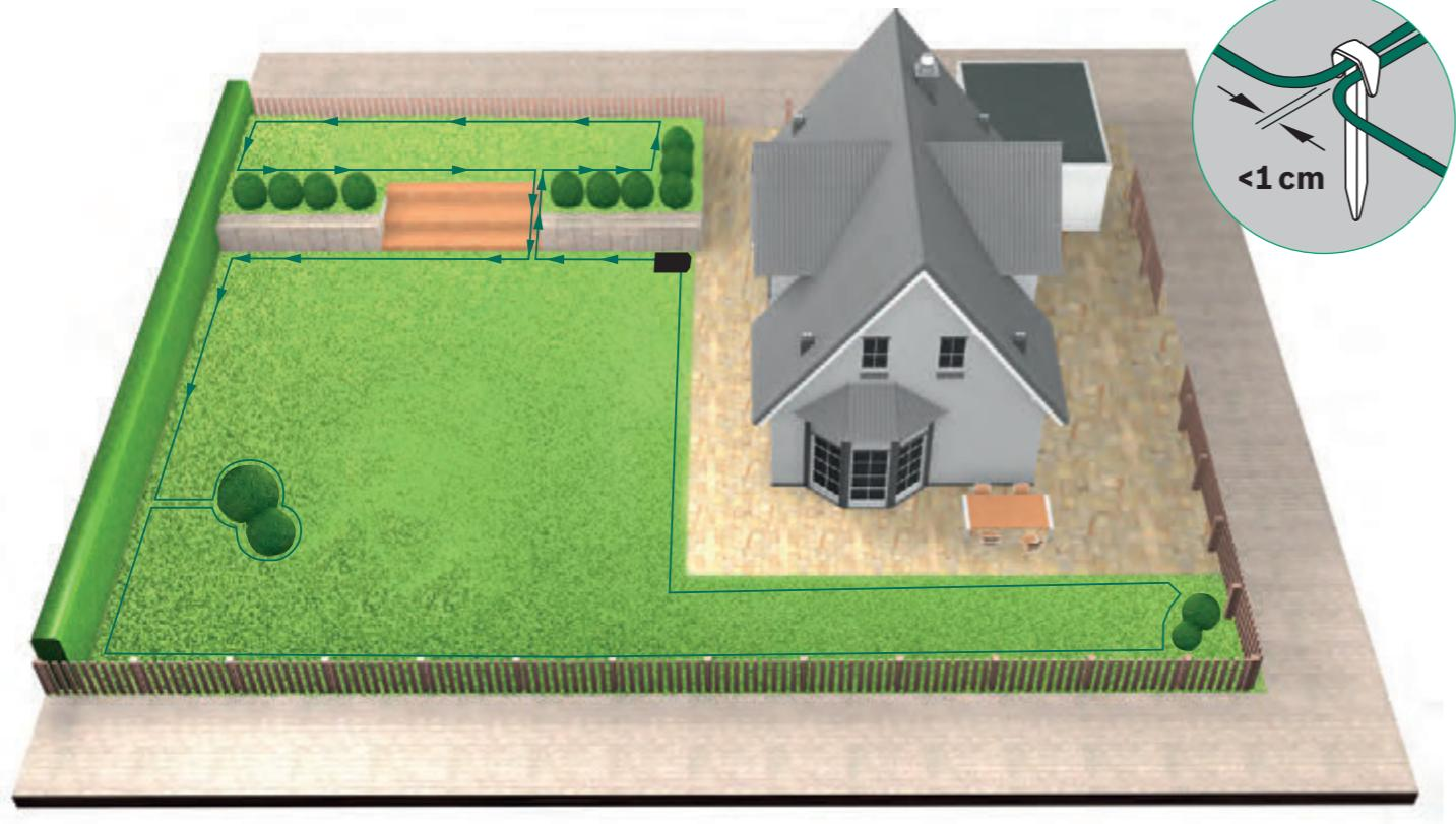
5.5 Položení vymezovacího obvodového kabelu kolem oddělených travních ploch (typ C viz část 1).
