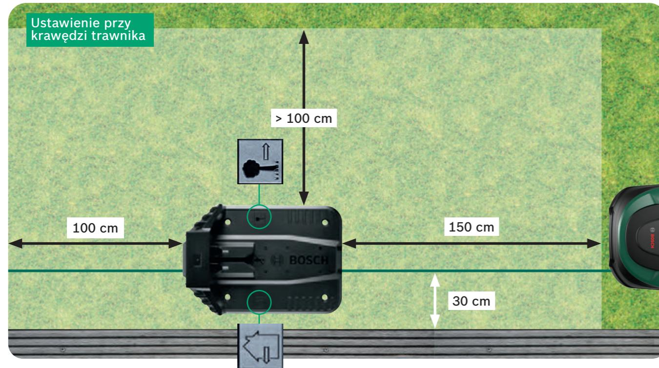
! Stacja dokująca jest istotnym punktem odniesienia dla kosiarki Indego. Każde odchylenie od schematu instalacji pokazanego na ilustracji może spowodować problemy z orientacją/działaniem kosiarki Indego, dlatego zalecamy scisłe trzymanie się wytycznych.
