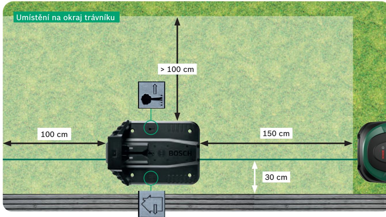
! Nabíjecí stanice je pro sekačku Indego důležitým referenčním bodem. Jakékoli odchyly od instalace, která je uvedena na obrázcích, mohou mít za následek problémy s navigací/funkčností sekačky Indego, a proto je nutné se jich vyvarovat.
