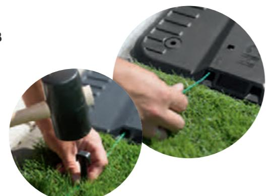
Убедитесь, что провод проложен прямо и полностью выровнен по отношению к кабельному каналу зарядной станции на протяжении 1,5 м.
