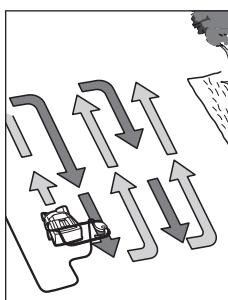
Coloque el producto en el borde de césped situado más próximo a la toma de corriente. Trabaje apartándose lateralmente de la toma de corriente en cada franja.
