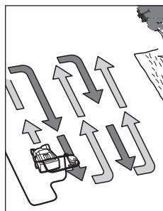
Postavite proizvod na rub travnjaka i što je moguće bliže mrežnoj utičnici. Radite dalje od mrežne utičnice. Nakon svakog okretanja postavite kabel na suprotnu, obradenu stranu. Prilikom prozračivanja/vertikuliranja travnjaka **ne preopterećujte motor.**
