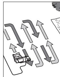
Novietojiet izstrādājumu zāliena malā pēc iespējas tuvāk elektrotīkla kontaktligzdai. Darba gaitā pakāpeniski pārvietojieties prom no elektrotīkla kontaktligzdas.
