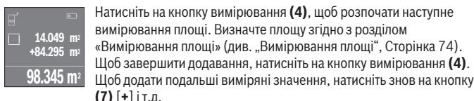
Натисніть на кнопку вимірювання (4), щоб розпочати наступне вимірювання площин. Визначте площу згідно з розділом «Вимірювання площин» (див. „Вимірювання площин“, Сторінка 74). Щоб завершити додавання, натисніть на кнопку вимірювання (4). Щоб додати подальші вимірюні значення, натисніть знов на кнопку (7) [+] і т.д.
