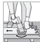
Griešanas laikā elektroinstrumenta vienmēr jāpārvieto atpakaļvirzienā. Pretējā gadījumā pastāv iespēja, ka griešanas disks tiks **nekontrolēti** mests ārā no griezuma. Griežot profilus un četrstūra caurules, ieteicams uzsākt griešanu vietā ar vismazāko šķērsgriezuma laukumu.
