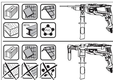
For at udnytte støvbeholderen optimalt bedes du bemærke følgende anvisninger:
